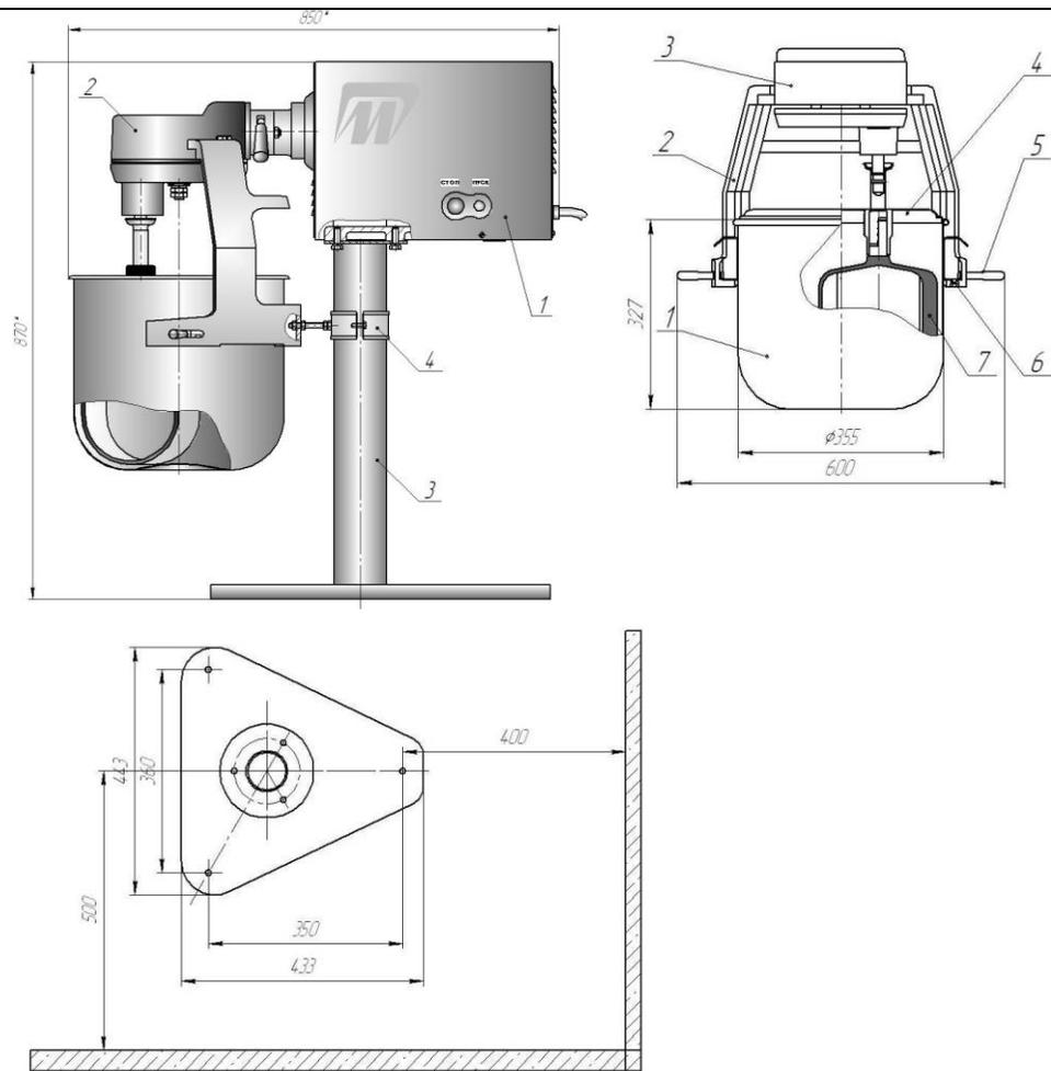
**Опора на полу расположена широкой частью в сторону бака**
