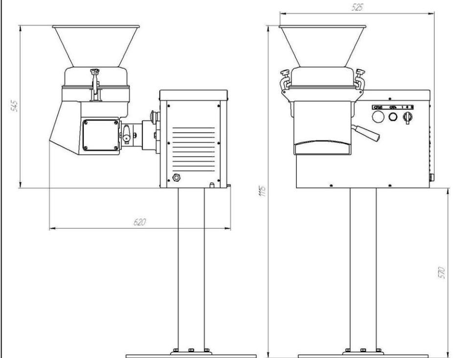
**Приводы ПМ и ПМ-Ч с механизмом МО – обязательно должны быть закреплены к подставке П-01 или к столу!**
