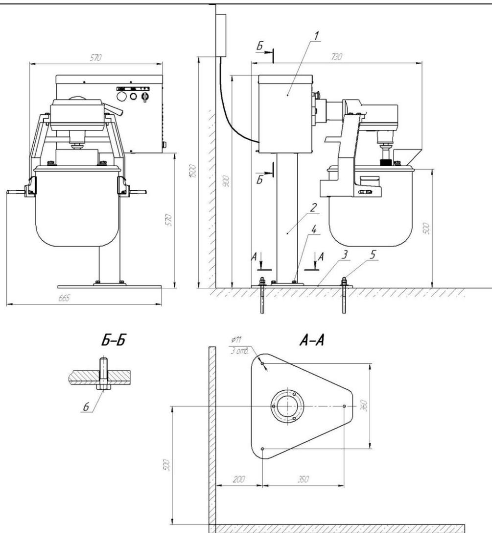
**Опора на полу расположена узкой частью в сторону бака**
