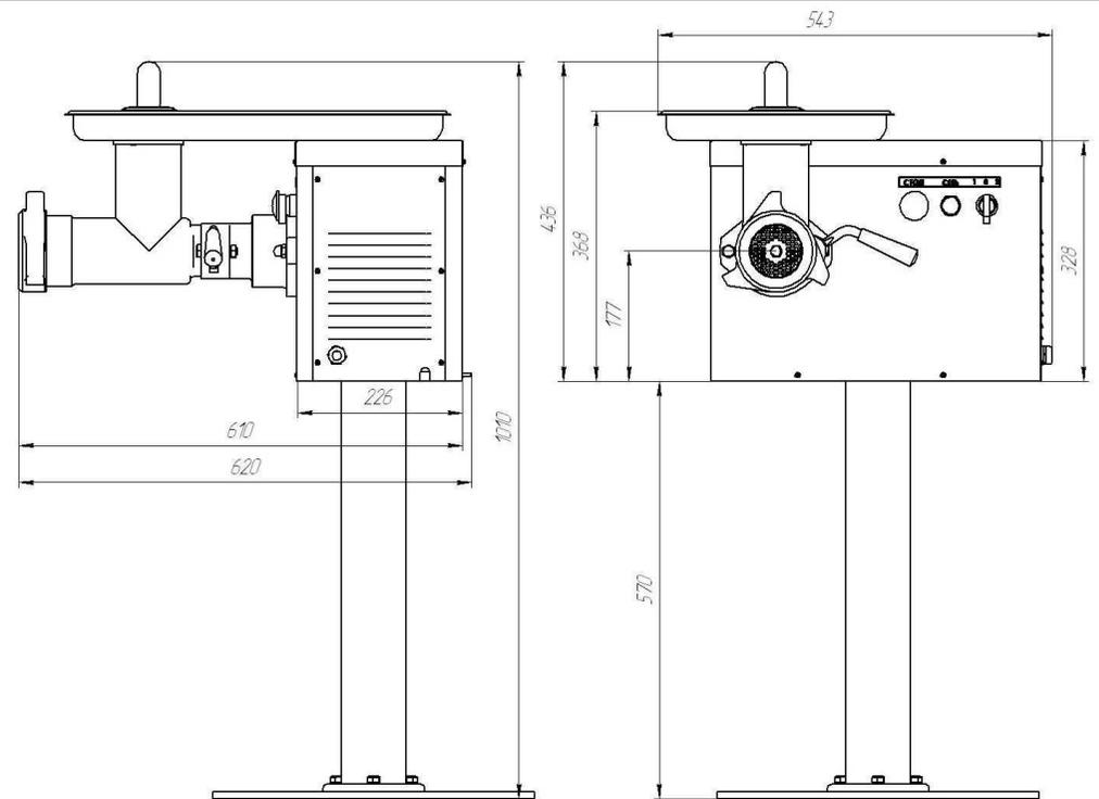
Привод ПМ-Ч с мясорубкой ММ обязательно должен быть закреплён к подставке П-01 или к столу!
